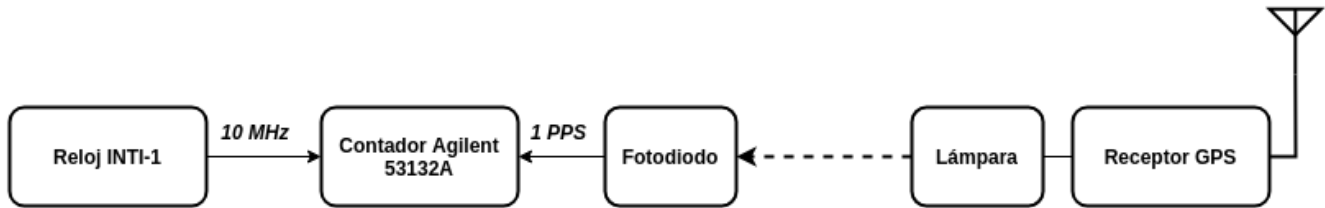
Figura 1: Diagrama de medición para la calibración del período de la señal luminica.
